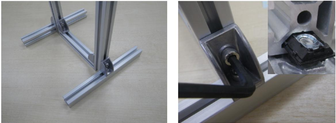
図21 アルミフレームへの脚の取り付け。
