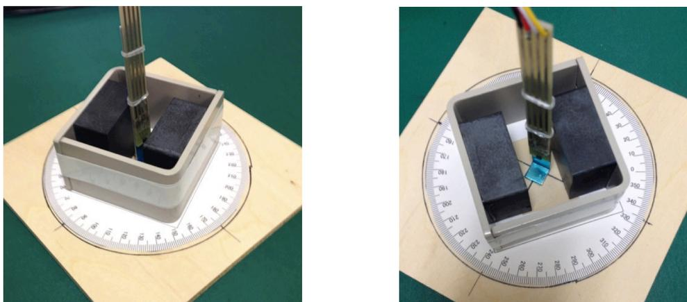
図 1 永久磁石セット。(敷板上に全周分度器, プローブ固定板, ホールプローブを取り付けた図)。
