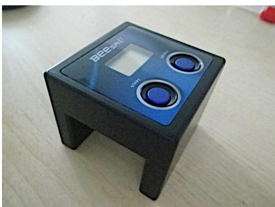
図1 ビースピ(速さ測定器)
