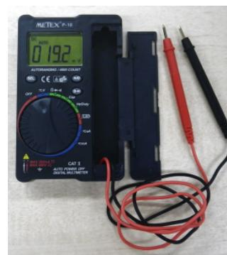
図 7 デジタルマルチメータ (大) とプローブの接続法. 図 8 デジタルマルチメータ (小).
