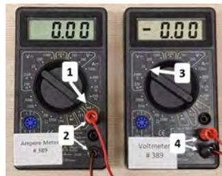
Figure 3 - 電流計と電圧計
