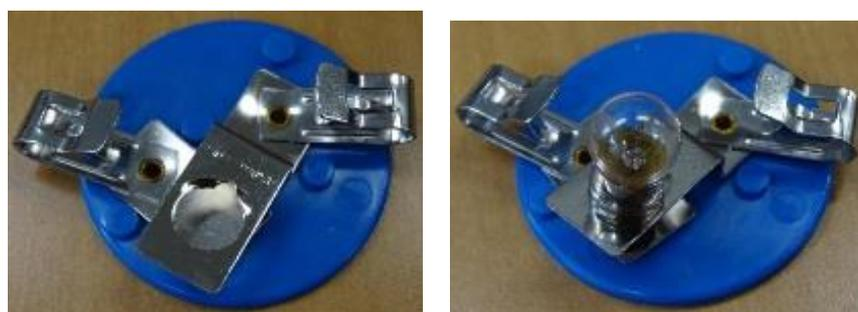
図 1-3 (a) 豆電球ホルダと (b) ホルダに豆電球を取り付けた写真
