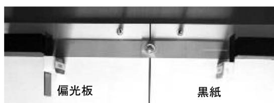
図 2-6 バックグラウンドの測定
