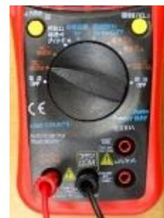
図 1-5 直流電圧測定時の端子接続及びロータリースイッチの位置
