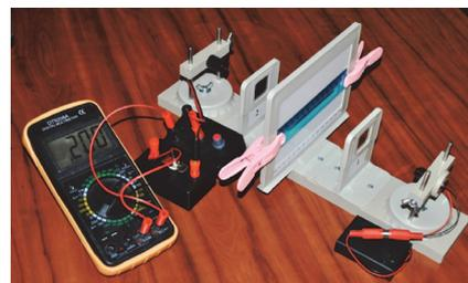
次に扱うのは液晶セルだ。液晶セルに印加する電圧を変化させていくと、透過光の強度は複雑な変動を示す。一見すると何の法則性もないようだが、注意ぶかく解析すると、実は位相差が印加電圧の簡単なべき関数になっていることがわかる。
